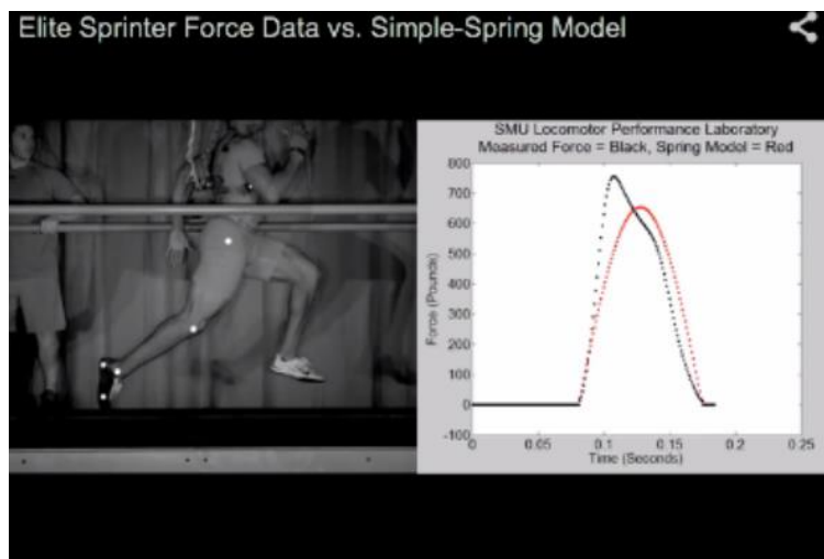
Figur 2: Sammenligning mellom en elitesprinters vertikale kraft og en enkel matematisk fjærmodell.
